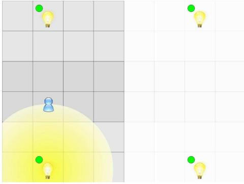
FIG. 9 – L’avatar est détecté par deux capteurs (zones représentées en gris). Il choisit d’allumer la lampe la plus proche de lui par opportunisme.
