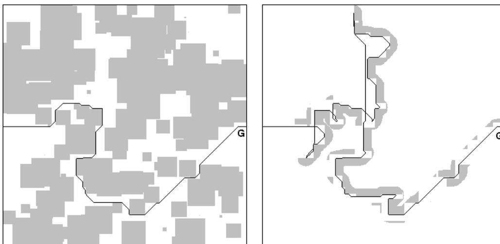
FIG. 2.11 – L'algorithme D\*. Sur ces figures, les zones grisées correspondent à des obstacles infranchissables. La figure de gauche présente le trajet optimal calculé par l'algorithme A\* qui connaît totalement l'environnement dès le départ. La figure de droite présente le trajet calculé par l'algorithme D\* en découvrant les obstacles au fur et à mesure du déplacement. Le résultat obtenu par l'algorithme D\* est proche de celui fourni par l'A\*.
