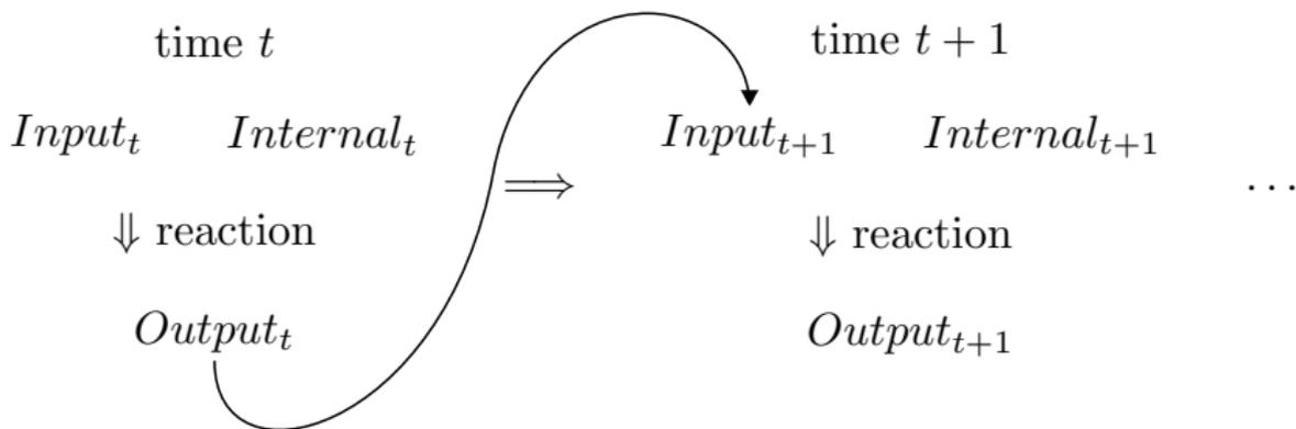
Calcul synchrone faible = séquence potentiellement infinie d'étapes de calcul. Quand l'espace d'état est fini, obtention d'une machine de Moore.
