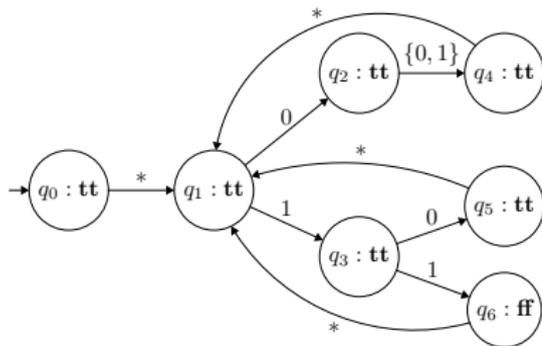
L'état  $q_6$  devient inatteignable dans la composition, et  $q_2$  et  $q_3$  ne sont plus séparables. Résultat de la composition séquentielle :
