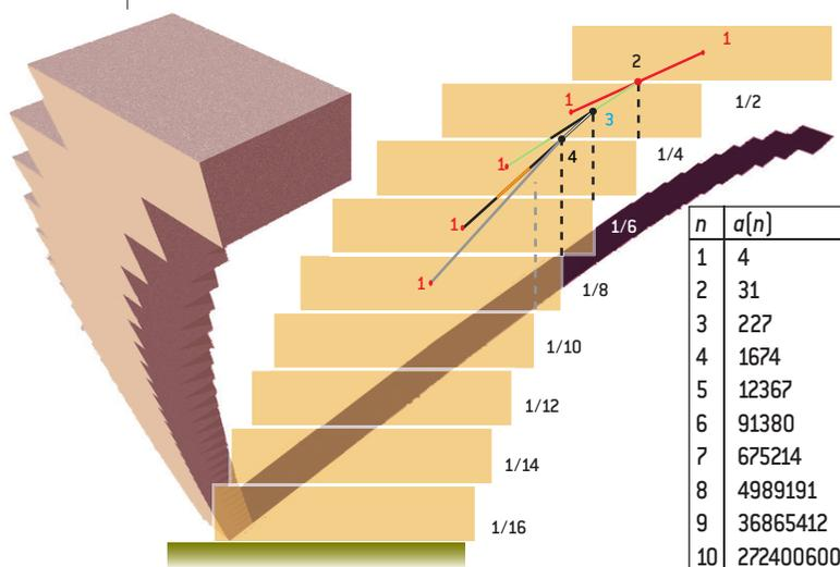
**1. Pile de briques en équilibre :** le centre de masse des  $n$  briques supérieures (de poids  $n$ ) et de la brique  $n + 1$  (de poids 1) est à l'aplomb de l'extrémité de la brique  $n + 2$ . Le surplomb d'une brique  $n$  par rapport à la brique inférieure  $n + 1$  est de  $1/(2n)$  pour des briques de longueur unité. Le tableau indique le nombre de briques nécessaires  $a(n)$  pour que l'on obtienne un surplomb de longueur  $n$  par la méthode de l'empilement logarithmique.
